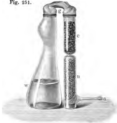
Verfahren von Erdmann und Unruh zur Wertbestimmung von Carbiden.
